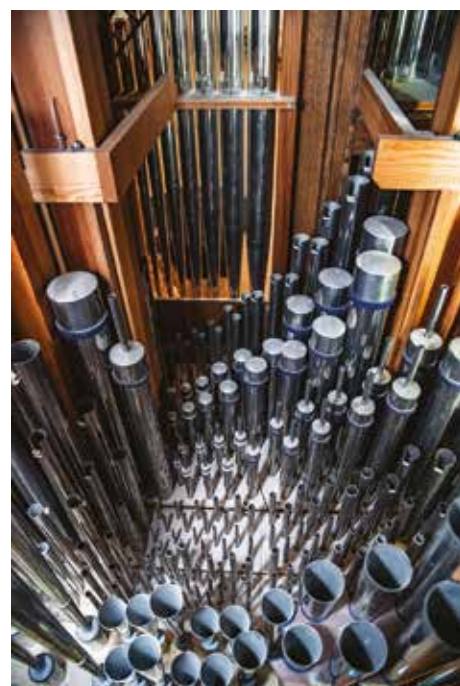
Часть виндлады I мануала Hauptwerk с трубами.
